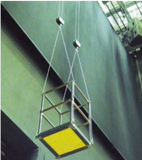
Ein einfaches, selbst erstelltes Personenaufnahmemittel
